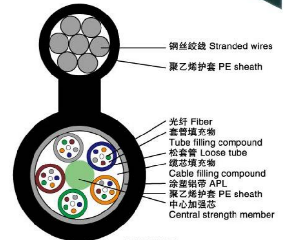
光缆结构图 Cable structure
